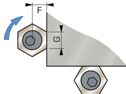
**Implantation** : réaliser des taraudages correspondant à la vis des crampons.
