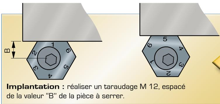
**Implantation** : réaliser un taraudage M 12, espacé de la valeur "B" de la pièce à serrer.
